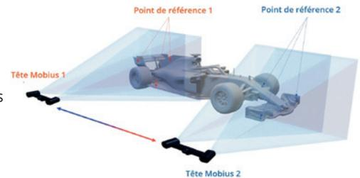
Le post-traitement des essais dans un système unifié de coordonnées est également possible en capturant les données des points de référence primaires et secondaires pendant l'essai.
